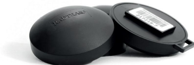
Radtrak<sup>2</sup> est un détecteur de traces alpha pouvant être utilisé pour mesurer la concentration en radon sur une période longue allant de 2 à 12 mois, mais également comme détecteur pour la dosimétrie professionnelle du radon. La plage de sensibilité de ce détecteur est telle qu'elle permet des mesures de niveau de concentration en radon allant de 15 Bq/m<sup>3</sup> jusqu'à 25 000 Bq/m<sup>3</sup> sur une période de 3 mois.
